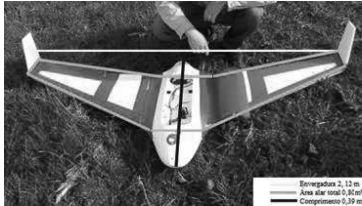
Figura 3. VANT adaptado para a elaboração do trabalho. Envergadura de 2,12 m, comprimento de 0,39 m e área alar total de 0,80 m 2 . Fonte: Slompo (2012).
