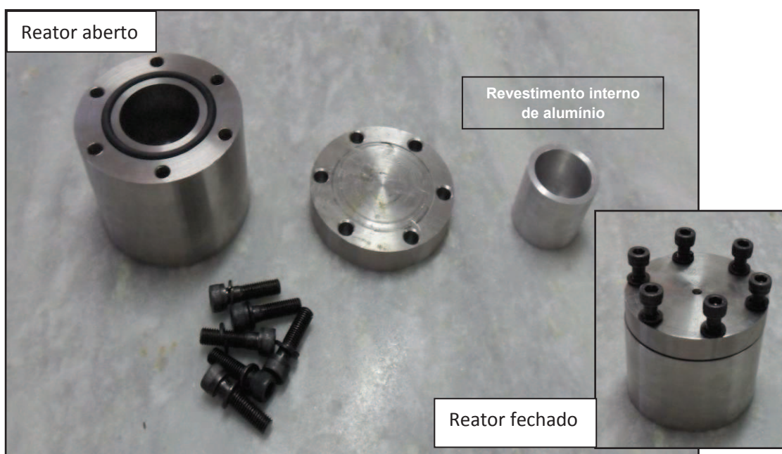
Figura 10. Foto do reator utilizado para a produção de biodiesel via catálise heterogênea a alta temperatura.
