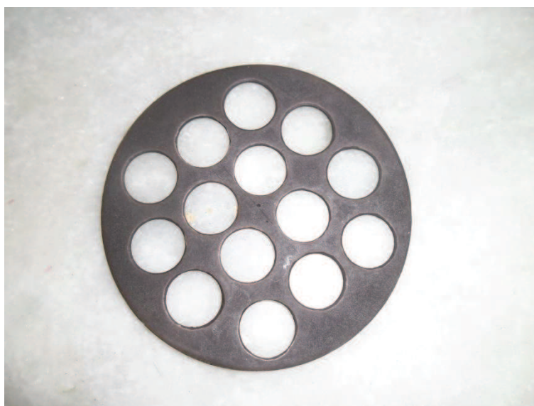
Figura 25. Imagem da superfície do alumínio recoberta pelo catalisador de níbio.
