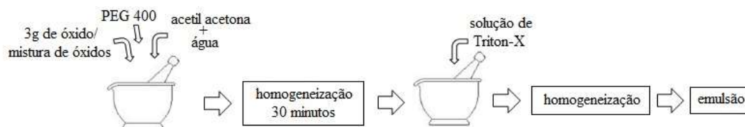
Figura 17. Representação do processo de obtenção da emulsão de óxidos.
