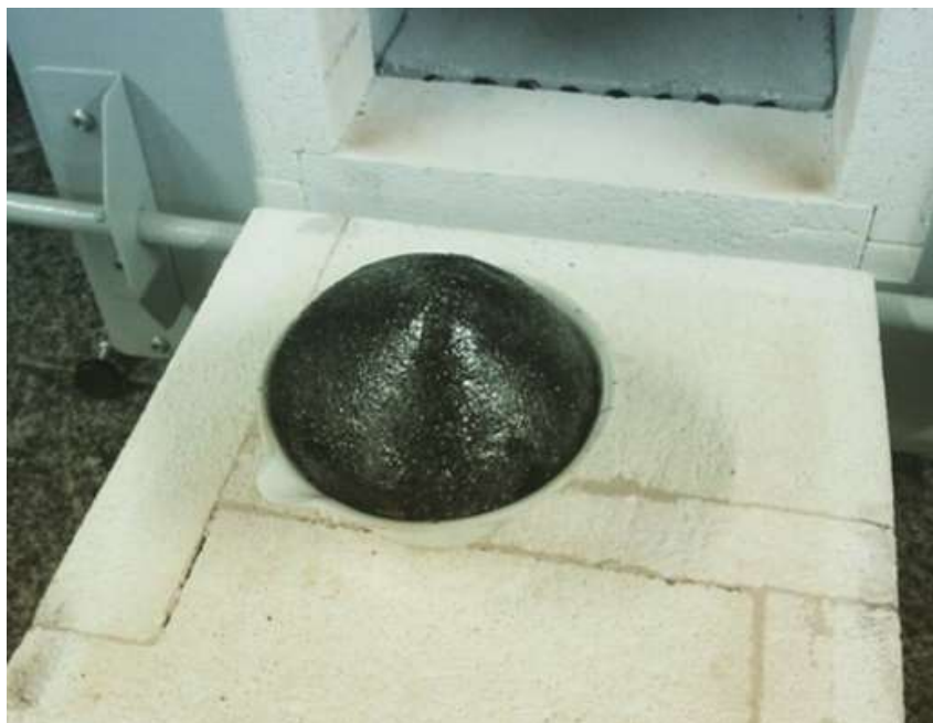
Figura 32. Polímero pirolisado “puff” obtido pela calcinação a 350 °C da resina polimérica para obtenção de partículas de pentóxido de nióbio. Proporções molares de etileno glicol:ácido cítrico 2,6:1 e de ácido cítrico:precursor metálico 1:0,3.
