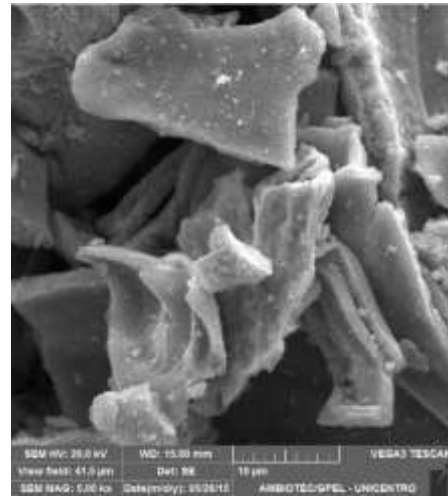
Figura 25. Imagens geradas por MEV de partículas de pentóxido de nióbio obtidas pelo método Pechini com aumento de A)1000 e B) 5000 vezes.
