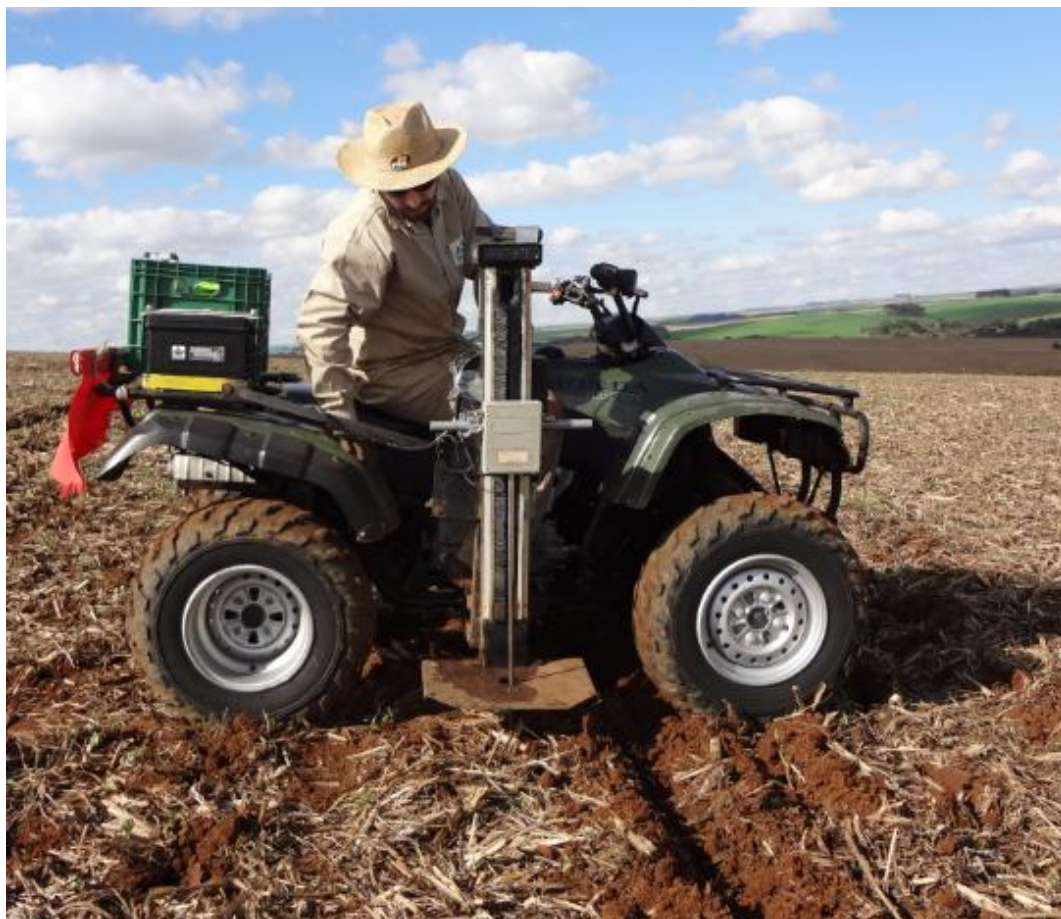
Figura 6. Conjunto amostrador eletromecânico de resistência do solo à penetração.
