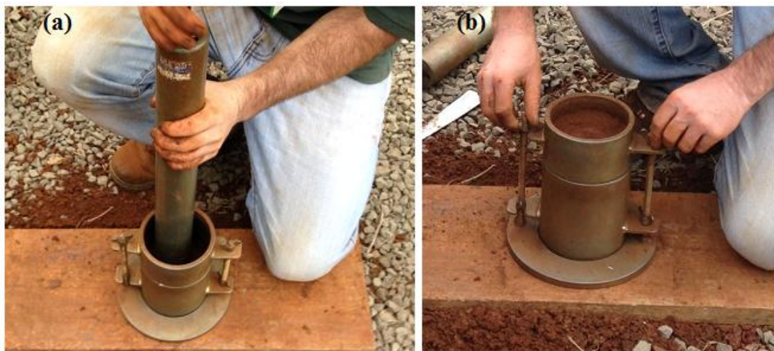
Figura 4. Cilindro e soquete do conjunto utilizado no ensaio de Proctor (a) e cilindro preenchido com a terceira camada de solo compactada (b).
