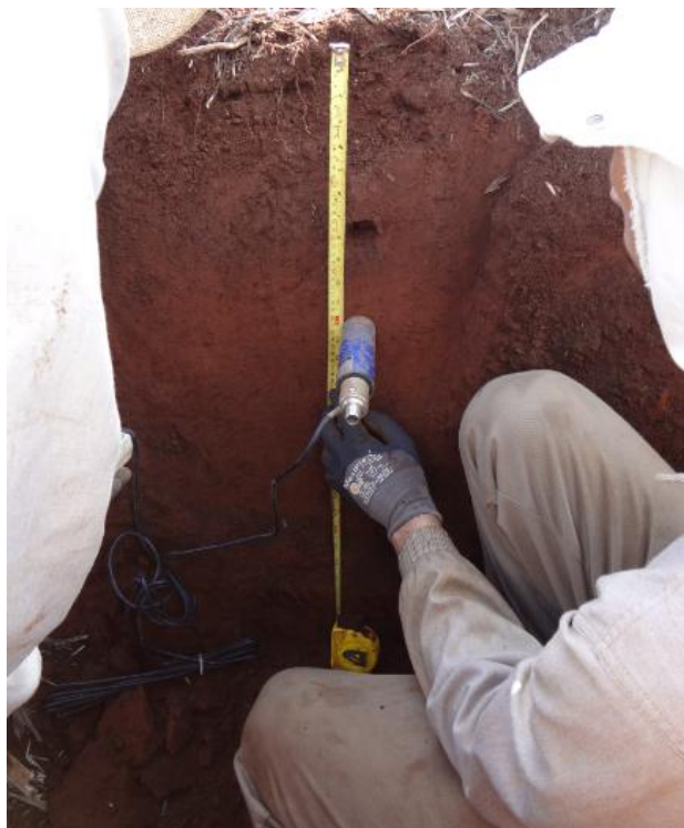
Figura 5. Avaliação da umidade por meio de um instrumento eletrônico portátil de obtenção da umidade gravimétrica instantânea
