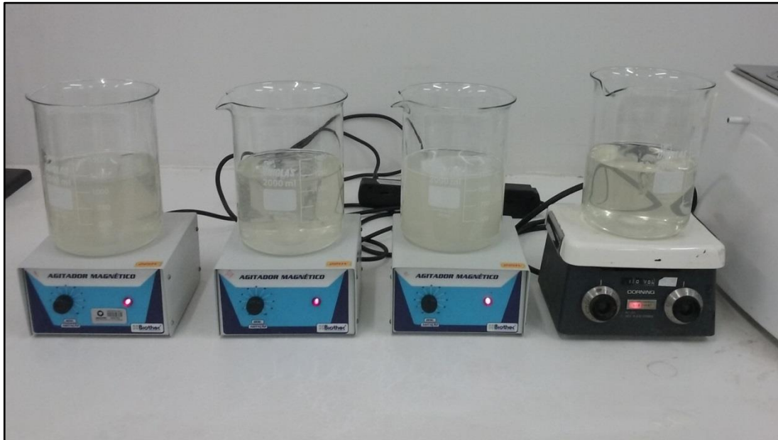
Figura 5 – Vista geral dos equipamentos para realização dos ensaios de desinfecção com APA.
