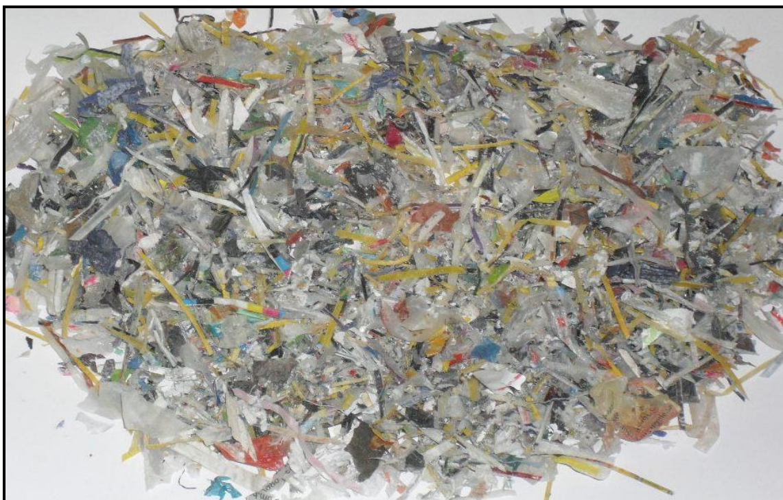
Figura 13 - RPH após secagem, retirada de metais e impurezas presentes e trituração.
