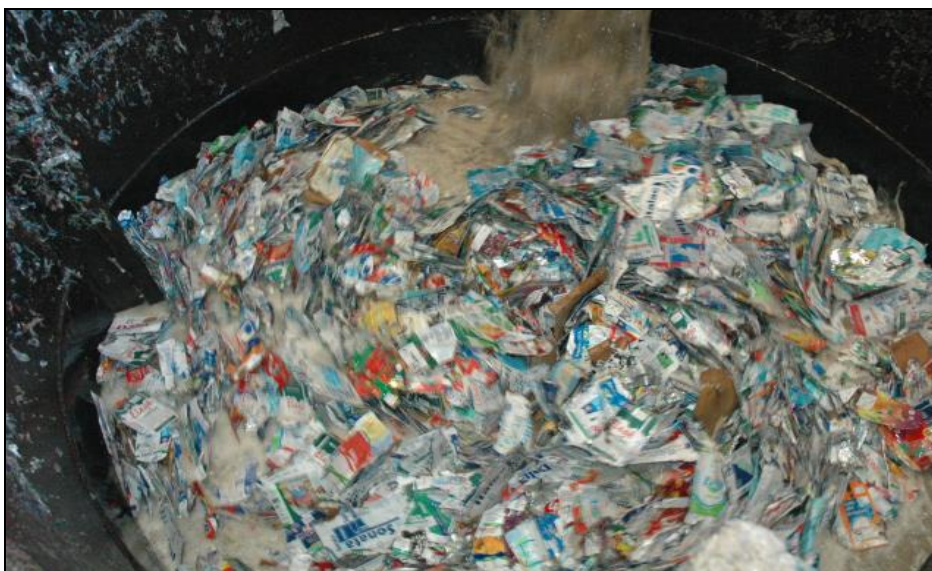
Figura 1 – Embalagens longa vida sendo recicladas em um equipamento hidrapulper [12] .
