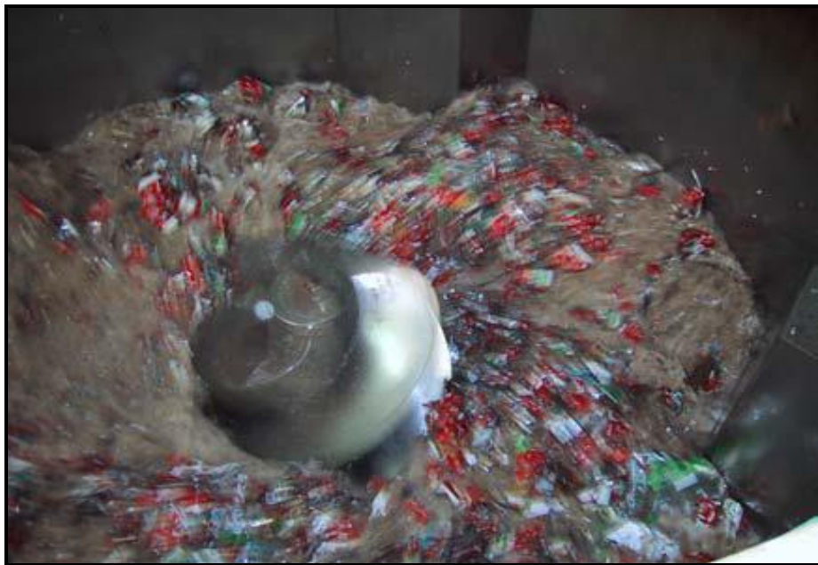
Figura 5 - Desagregação de embalagens longa vida em alta consistência [13] .
