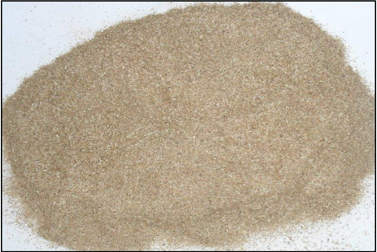
Figura 16 - Fibras de bagaço de cana-de-açúcar após secagem e trituração.
