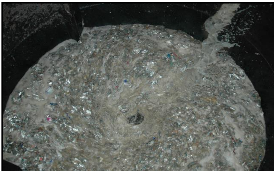
Figura 2 – Desagregação das embalagens de longa vida, produzindo uma pasta celulósica que será utilizada para fabricar artefatos de papel e liberando como subproduto, plástico e alumínio [12] .
