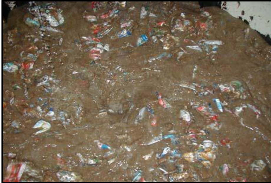
Figura 4 – Desagregação de embalagens longa vida em baixa consistência [13] .
