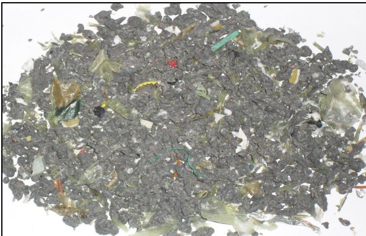
Figura 14 - RPH após o processo de aglutinação.
