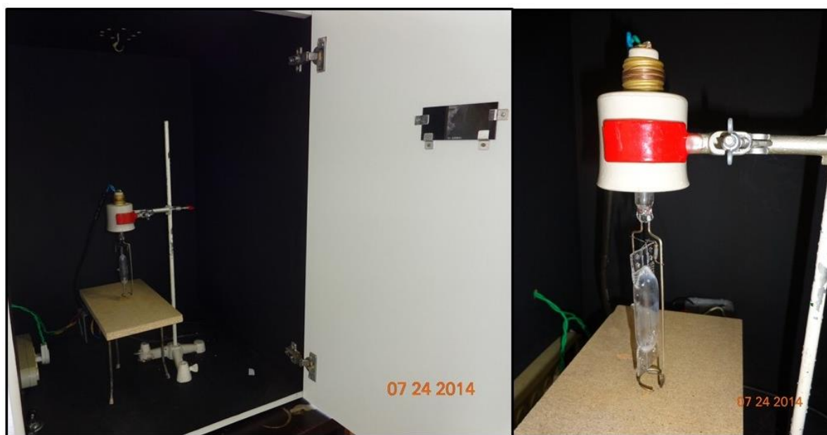
Figura 3.2. Digestor UV utilizado para o preparo das soluções de açúcar mascavo usando a reação de Foto-Oxidação UV (Fonte: Arquivo pessoal).
