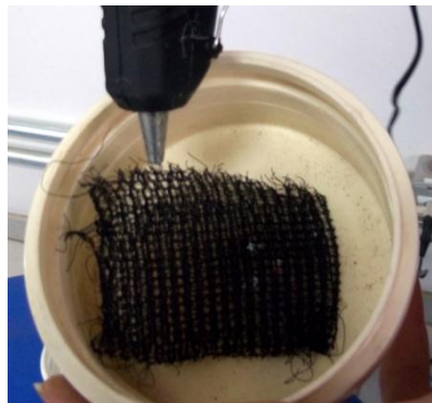
Figura 5. 3 - Fotografia da colagem do sombrite no cap inferior.
