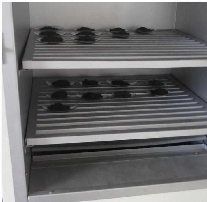
Figura 11. Amostras de solo para serem secas na estufa
