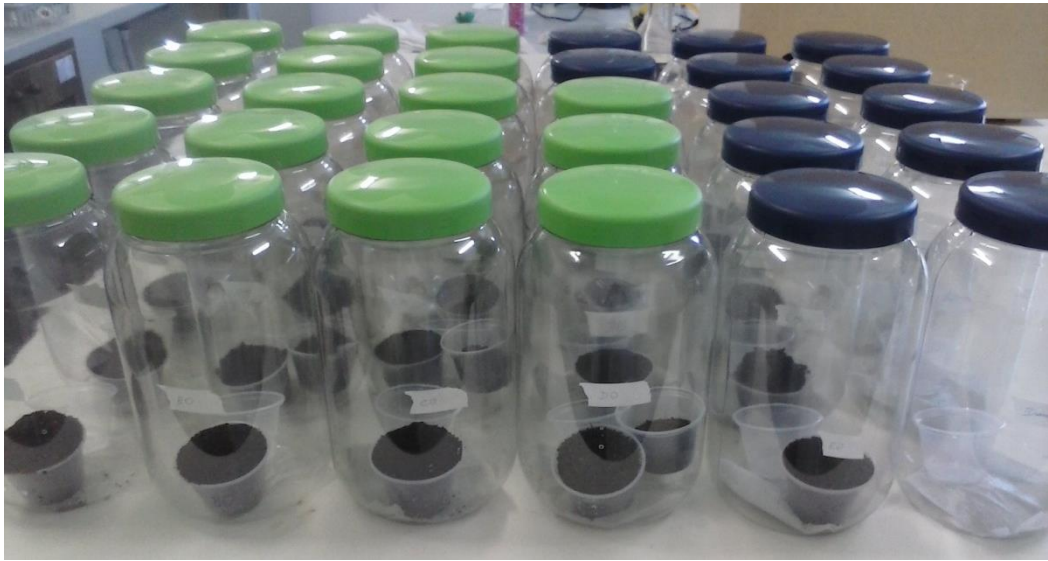
Figura 12. Incubadoras com o solo, NaOH e papel umedecido para determinação da RBS. À direita da figura estão as incubadoras que funcionaram como controle
