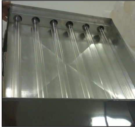
Figura 2 – Ilustração do modelo das lâmpadas germicidas UV de vapor de mercúrio de baixa pressão utilizadas na presente pesquisa.
