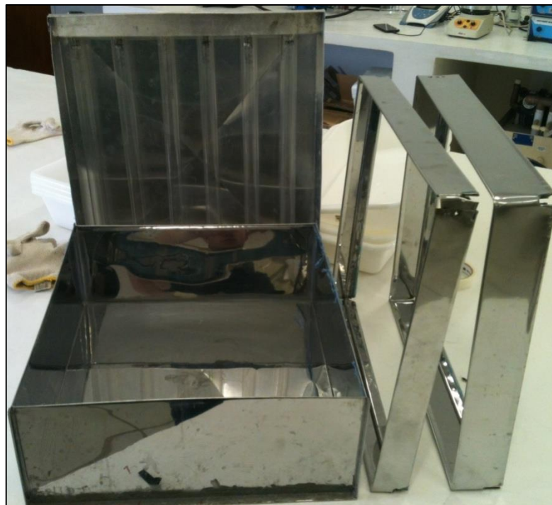
Figura 6 – Fotografia do reator UV de bancada e dos adaptadores.
