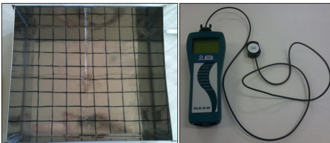
Figura 7 - Malha de pontos no fundo do reator UV e radiômetro que foram utilizados na pesquisa.
