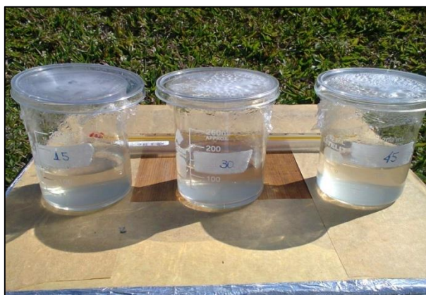
Figura 12 - Alíquotas de 100 mL do efluente expostas por três horas ao sol para o ensaio de fotorreativação.
