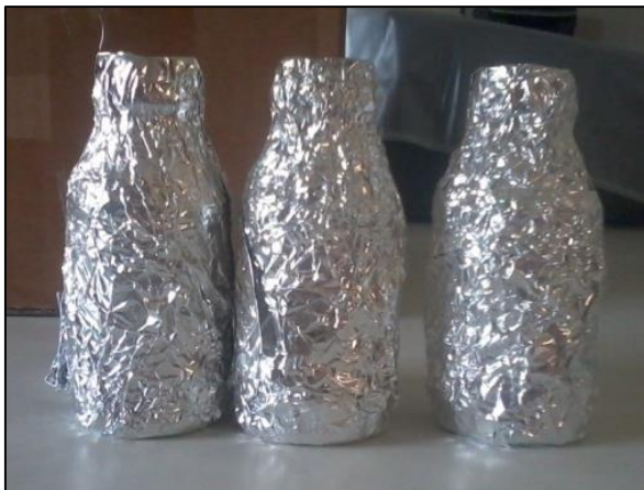
Figura 13 - Alíquotas de 100 mL de efluente expostas por três horas em ambiente escuro.
