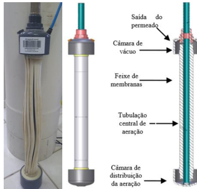
Figura 7 - Imagem e esquema do módulo de membranas.
