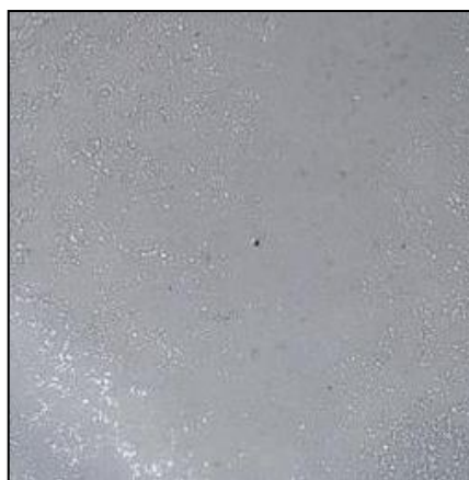
Figura 32 - Biopolímero de PVA/quitosana impregnado com o indicador de pH extraído da bráctea da inflorescência da bananeira.
