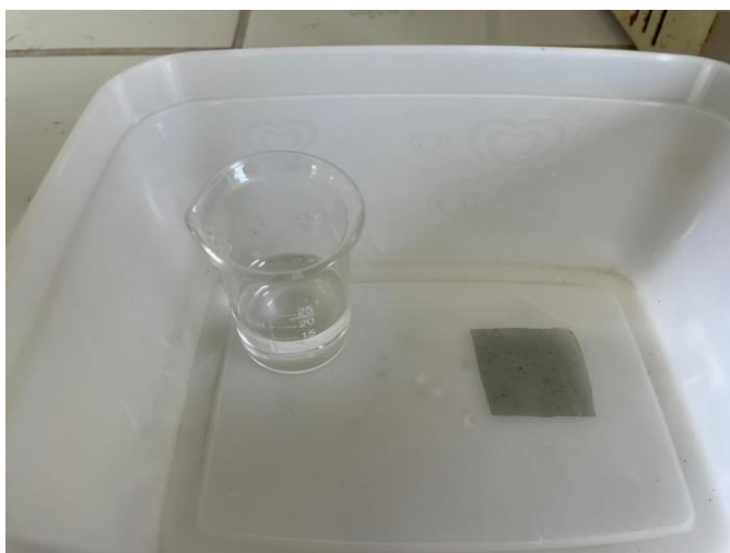
Figura 18 - Teste de Sensibilidade do biopolímero indicador antes da mudança de cor
