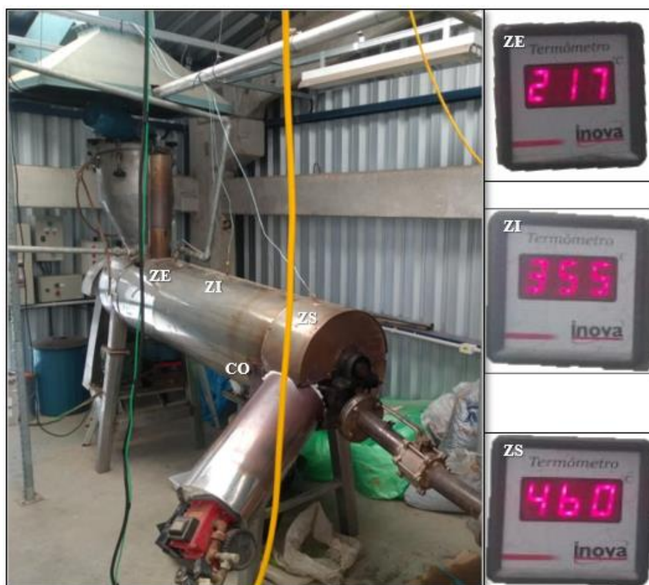
Figura 4. Reator de pirólise do tipo rosca transportadora-screw reator (Pirólise de biomassas/resíduos). Nota: ZE= zona de entrada; ZI= zona intermediária; ZS= zona de saída; CO= coletor.
