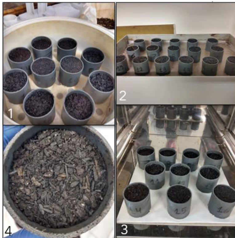
Figura 10. Procedimento para obtenção do volume de água e volume de ar das amostras.
