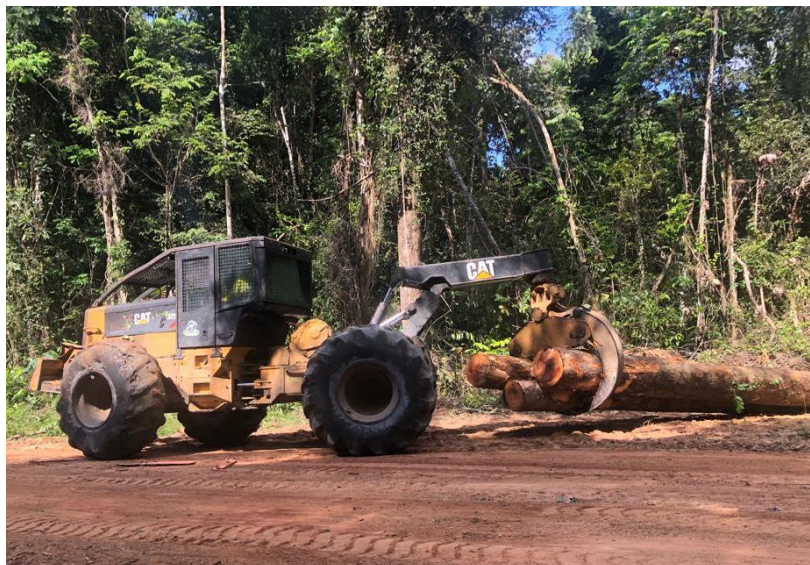
Figura 19. Skidder arrastando mais de uma árvore utilizando uma única trilha na atividade de extração, na UPA 17.
