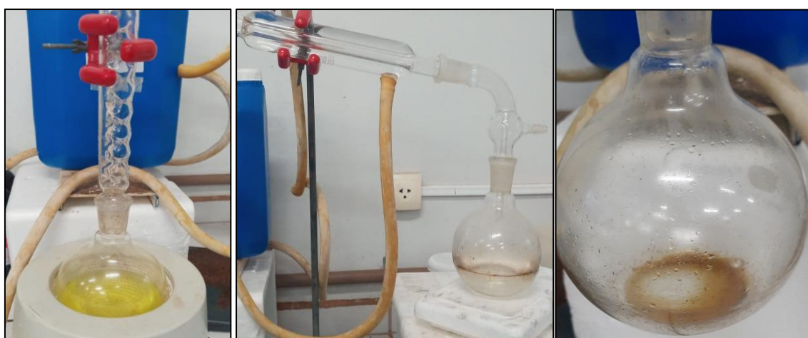
Figura 8. Processo de recuperação do hexano para obtenção do óleo bruto, por processo de destilação. Fonte: O Autor, 2022.
