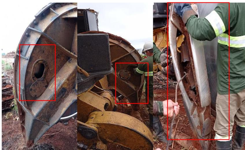
**Figura 25.** Limpeza para destravar o disco de corte do *feller buncher*.
