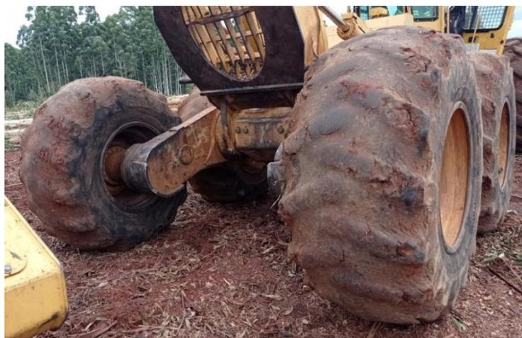
**Figura 14.** Condições observadas dos pneus do *skidder* na extração da madeira em ambas as angulações.
