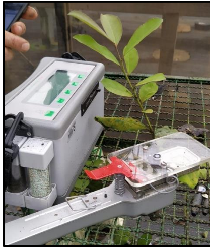
Figura 7. Sistema portátil de medidas de fotossíntese (IRGA, Infrared Gas Analyzer, Li-cor, LI6400XT).
