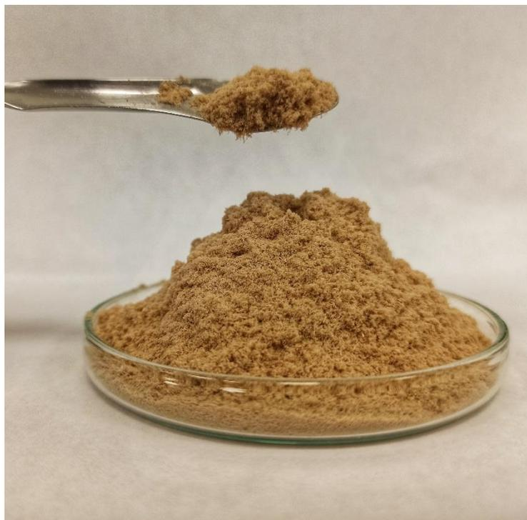
Figura 1. Amostra de serragem, processada em moinho ciclone, para coleta de espectros NIR.
