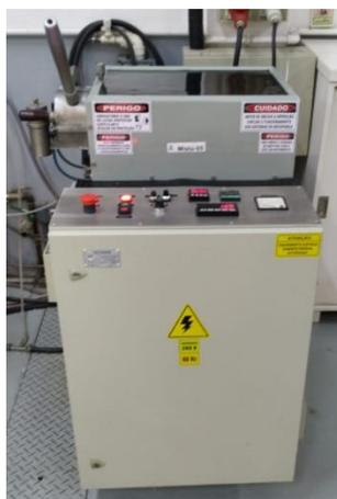
**Figura 7.** Homogeneizador "Drais".
