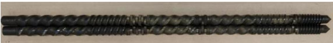
**Figura 11.** Fusos da mini-extrusora corrotativa. Fonte: Uminho
