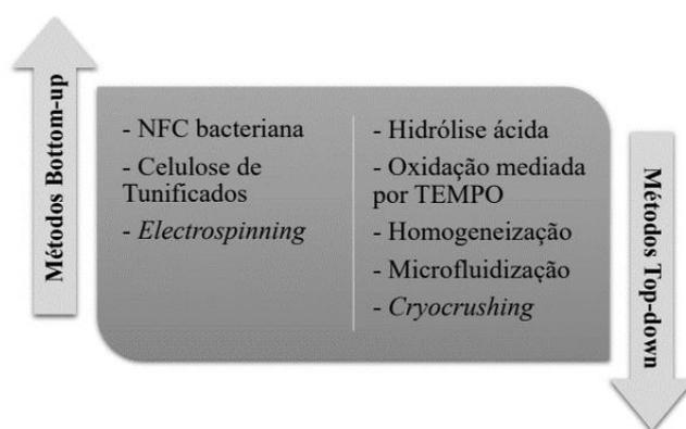
**Figura 1.** Métodos de produção de nanocelulose. Top-down e Bottom-up.
