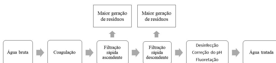
Figura 4 – Representação esquemática do sistema de dupla filtração
