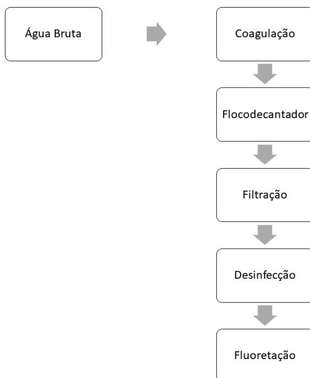
Figura 10 – Fluxograma geral da estação de tratamento de água utilizada na presente pesquisa.
