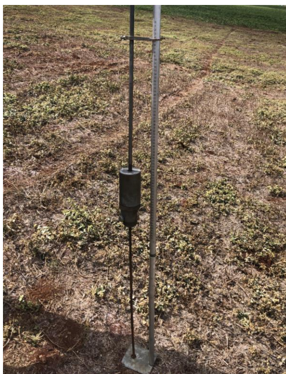
Figura 12 – Ensaio com Penetrômetro de impacto
