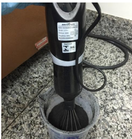
Figura 4. Homogeneização dos aglutinantes com os finos de carvão
