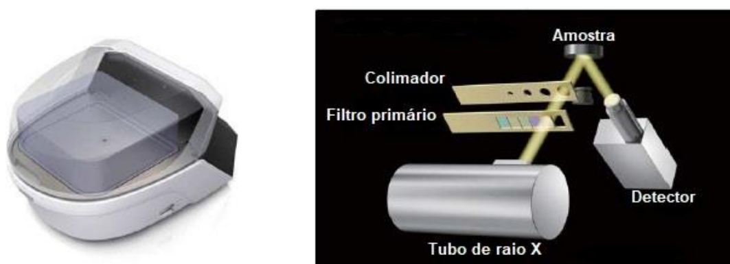
Figura 5: Esquema representativo do funcionamento da técnica de EDXRF , com imagem do equipamento
