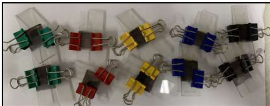
Figura 14. Montagem das células em formato sanduíche
