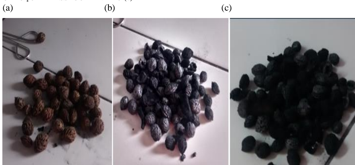
FIGURA 3 – CAROÇO DE PÊSEGO IN NATURA (a); CAROÇO DE PÊSEGO CARBONIZADO (b); CAROÇO DE PÊSEGO ATIVADO (c)
