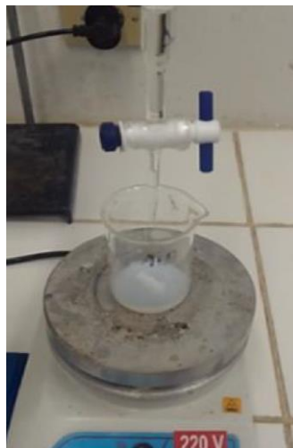
Figura 3- Produção das nanopartículas por método de coacervação
