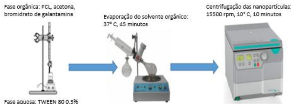
Figura 5. Esquema de obtenção de nanopartículas de PCL contendo bromidrato de galantamina (FONTE: o autor).
