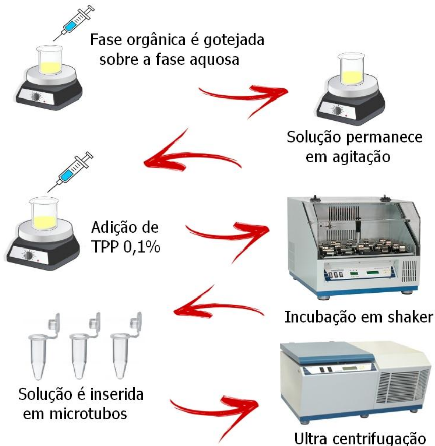
Figura 5: Processo de obtenção de nanopartículas de caseína pelo método de coacervação.
