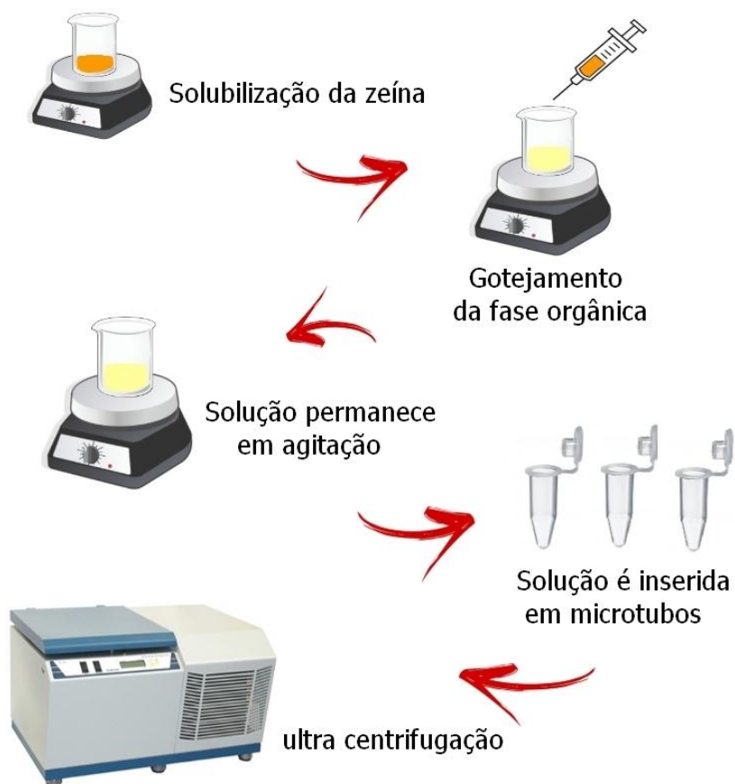
Figura 6: Processo de obtenção de nanopartículas de zeína pelo método de dispersão líquido-líquido.
