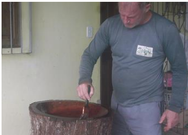
Figura 19: Aplicação de resina poliéster na cuba da pia (Fonte: autor).
