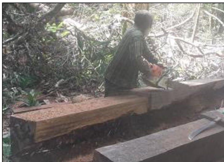
Figura 14: Resíduo de desdobro de madeira na floresta que serviu para confecção do aparador (Fonte: autor).
