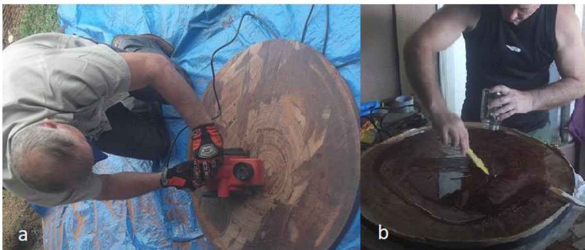
Figura 22: (a) Aplainamento do tampo, (b) Aplicação de resina cristal (Fonte: autor).
