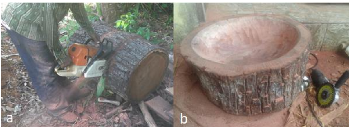
Figura 17: (a) Corte da peça de maçaranduba para a pia de madeira, (b) Pia de madeira escavada com disco de corrente de motosserra (Fonte: autor).
