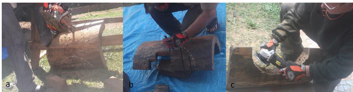
Figura 21: (a) escavação da base feita com motosserra, (b) retirada do excesso com formão, (c) aplainamento e moldagem da base com esmerilhadeira (Fonte: autor).
