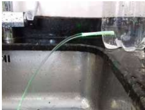
Figura 26: raio de luz curvado na água
