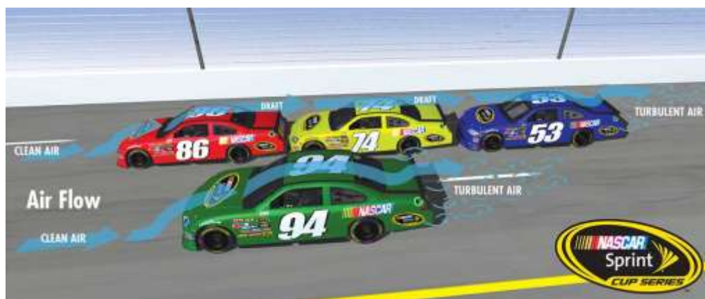
Figura 31: Representação dos vórtices de ar em carros de corrida.
