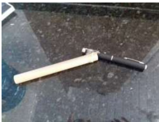
Figura 11: laser fixo no cano pvc
