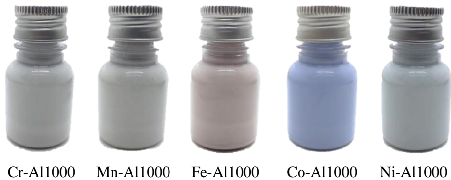
FIGURA 28: IMAGEM FOTOGRÁFICA DAS TINTAS PIGMENTADAS COM OS ALUMINATOS (1000 °C)
