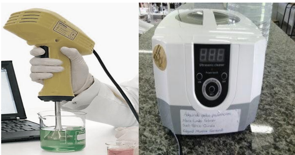
Figura 5. a) Ultrassom tipo sonda com UP200Ht (Fonte: Hielscher ultrasonics technology, 2016), b) banho de ultrassom (Spencer, modelo CD 4800) (Fonte: Arquivo pessoal).
