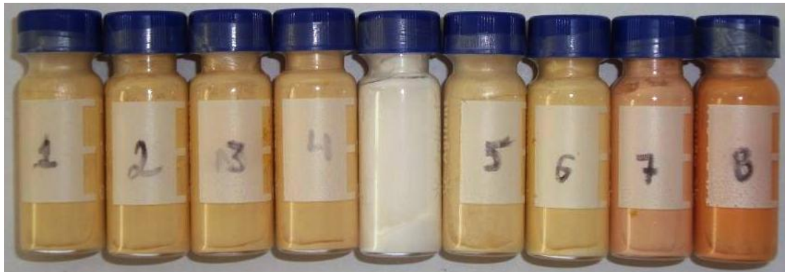
Figura 21. Testes de dispersão dos pigmentos em tinta branca, Akaganeita (frascos 1, 2, 3 e 4), Goethita (frascos 5 e 6) e Hematita (frascos 7 e 8)
