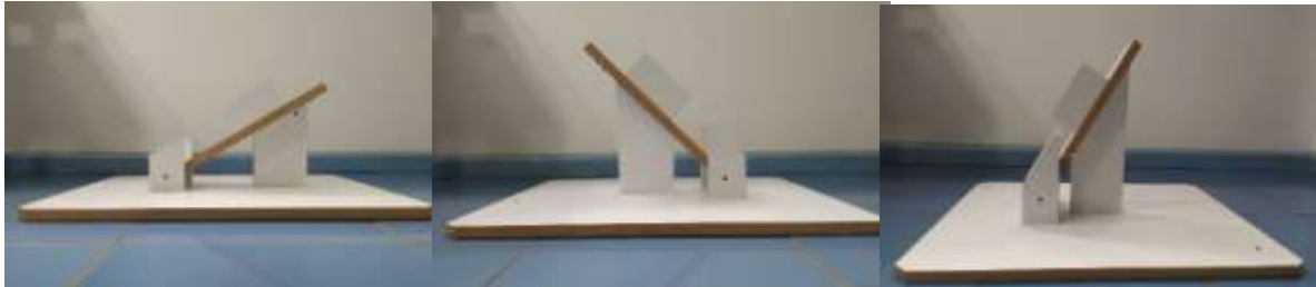
Figura 10 - Bases de lançamento com ângulos de 30°, 45° e 60°
