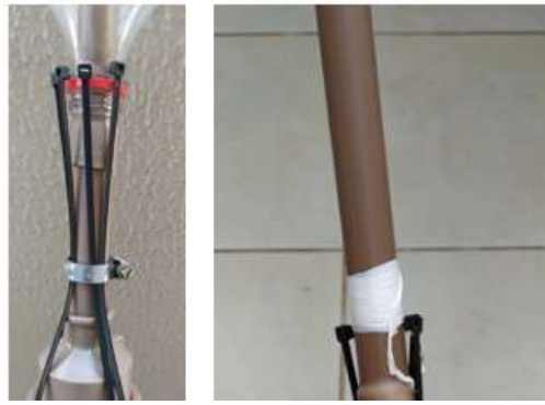
Figura 21 - Montagem do cilindro de ar Fonte: Imagens do arquivo pessoal, março de 2020
