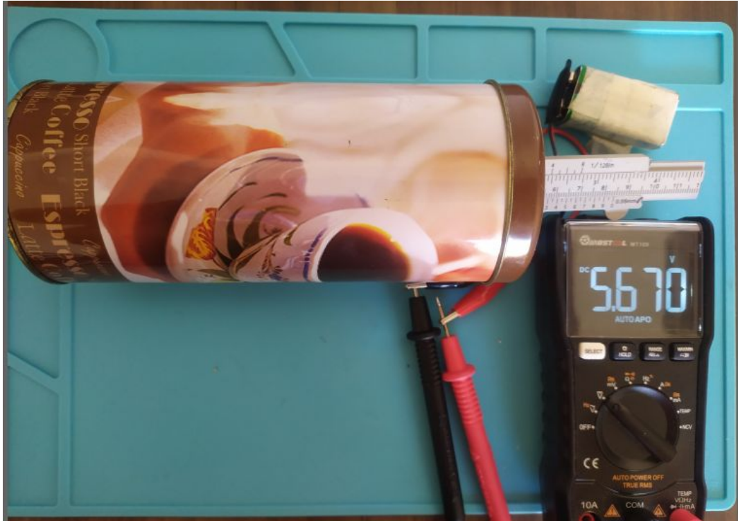
Figura 16 - Detector finalizado, com o multímetro medindo a ionização da amostra radioativa.
