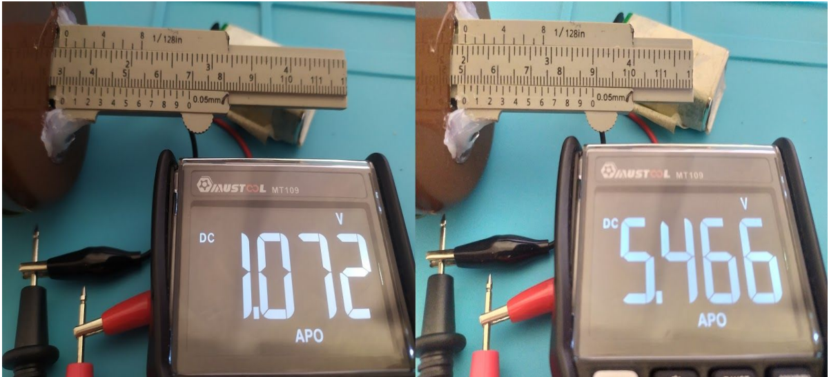
Figura 6 - Mudança da posição da fonte radioativa e seu respectivo sinal de tensão obtido.
