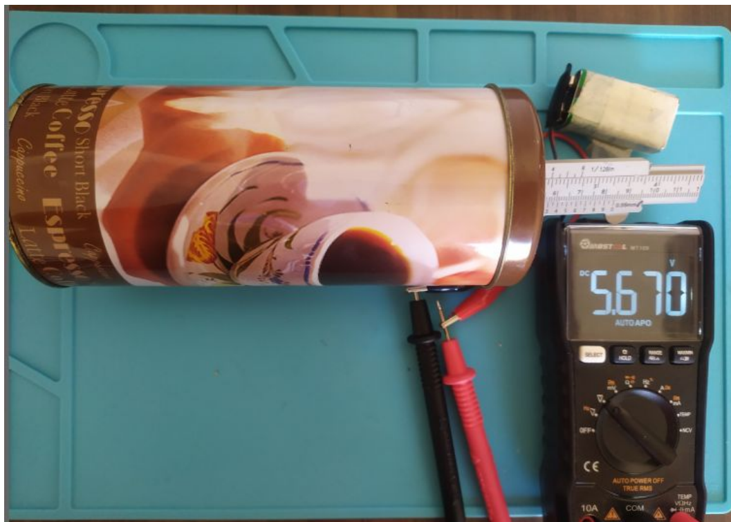
Figura 5 - Detector finalizado, com o multímetro medindo a ionização da amostra radioativa.
