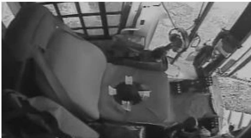
Figura 9. Localização do seatpad fixado no assento da máquina para a coleta da vibração de corpo inteiro.
