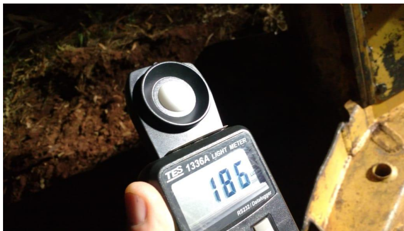
Figura 11. Coleta de dados com o luxímetro no período noturno.
