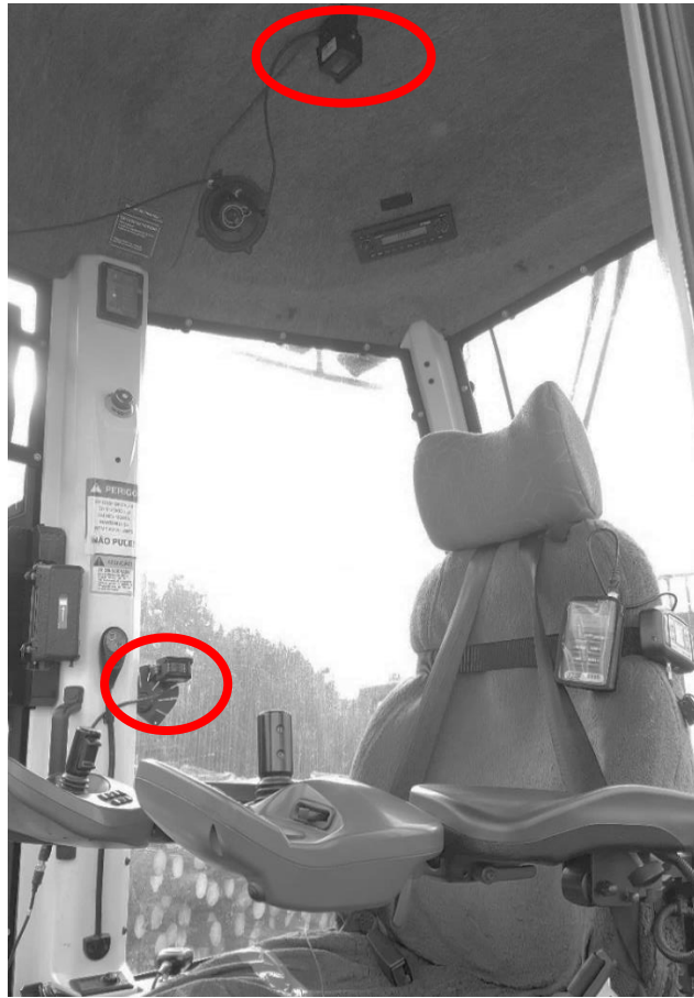
Figura 12. Localização das duas câmeras instaladas no interior da cabine.
