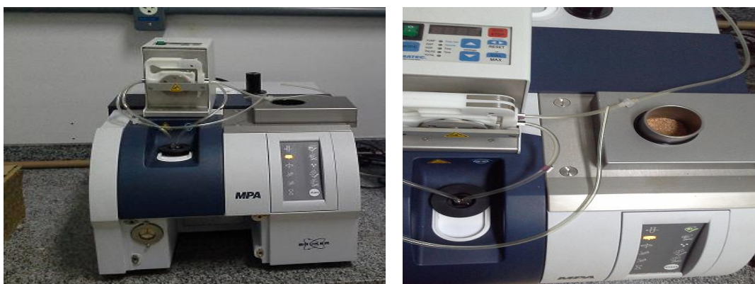
Figura 13 - Espectrofotômetro utilizado para coleta de espectros na faixa de 4000 -12000 \text{cm}^{-1}
