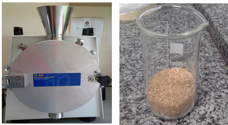
Figura 11 – Moinho de facas utilizado na moagem da madeira e serragem obtida após moagem, utilizadas para coleta de espectros para densidade da madeira de E. benthamii
