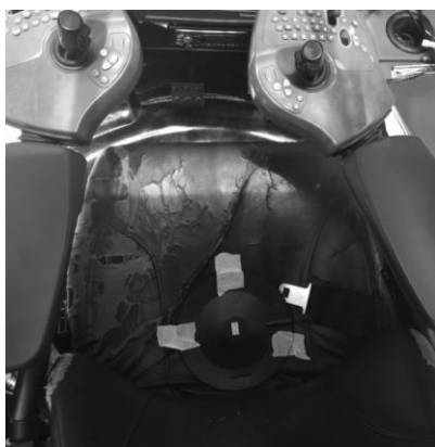
Figura 9. Posicionamento do medidor de vibração no assento
