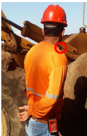
Figura 11. Operador com o audiosímetro instalado.
