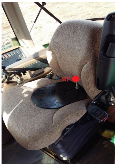
Figura 4. Dispositivo para determinação do SIP posicionado sobre o assento do trator.
