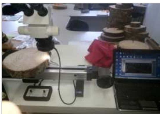
Figura 9. Medição dos anéis de crescimento no LINTAB 6.
