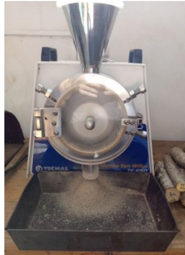
Figura 3. Moinho tipo willye de laboratório, marca TECNAL, modelo T6 – 650.
