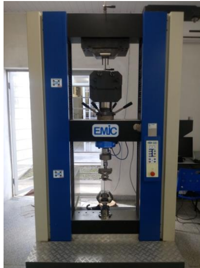
Figura 9. Máquina universal de ensaio. Ensaio de tração em andamento.
