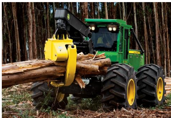
Figura 4. Trator florestal skidder . Fonte: John Deere .
