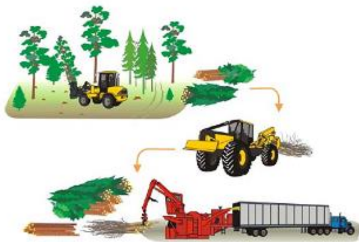
Figura 3. Cavaqueamento de biomassa em sistema de colheita de árvores inteiras. Fonte. Leinonen (2004).
