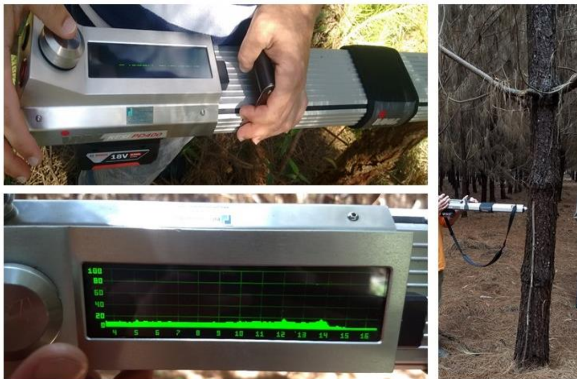
Figura 4 - Avaliação da resistência da madeira com Resistógrafo IML Resistograph ® em teste de progênies de Pinus maximinoi aos 5 anos de idade em Telêmaco Borba, PR. Fonte: O Autor (2019).
