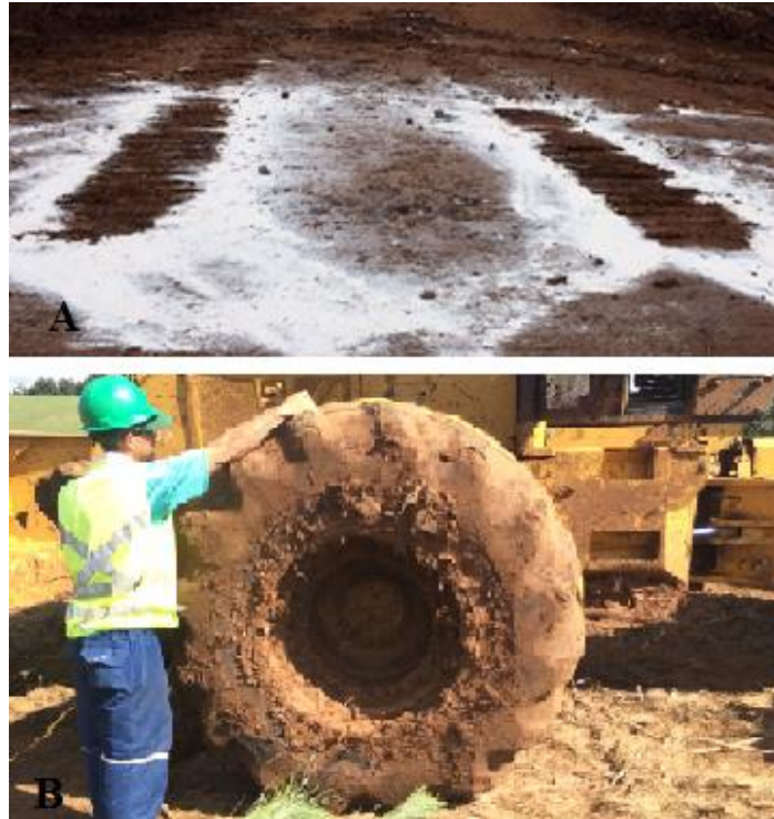
Figura 8. Rodados de esteira do feller direcional demarcados com cal (A) e medição do diâmetro do pneu do skidder utilizando fita métrica (B).
