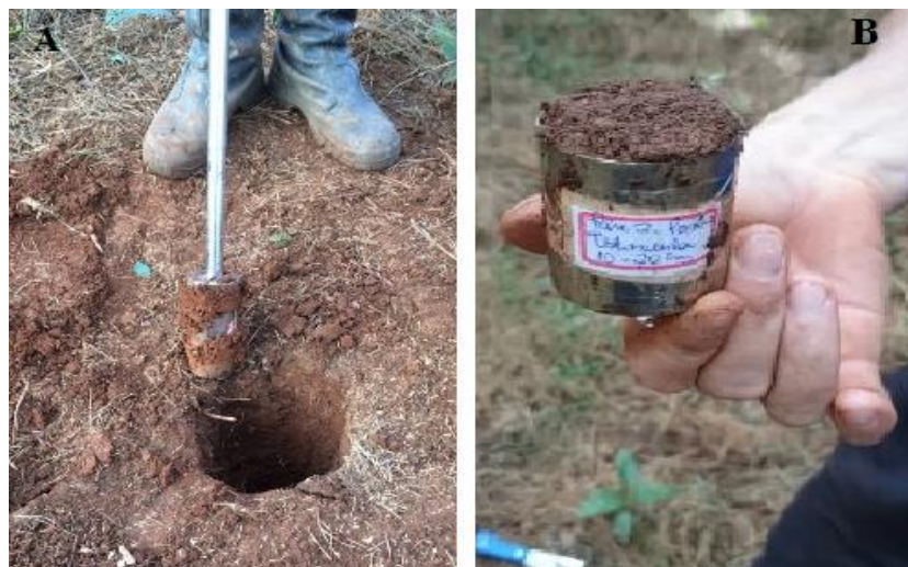
Figura 9. Trado de amostras indeformadas (TAI) (A) e anel volumétrico preenchido com solo (B).
