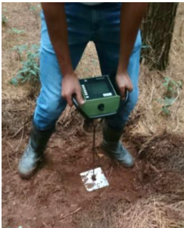
Figura 11. Medição da resistência mecânica à penetração com uso do penetrômetro digital.
