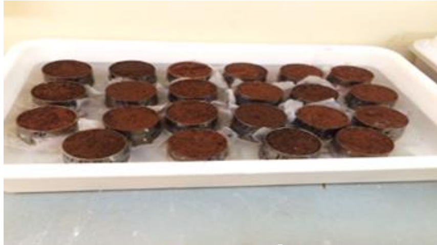
Figura 10. Anéis volumétricos em processo de saturação.
