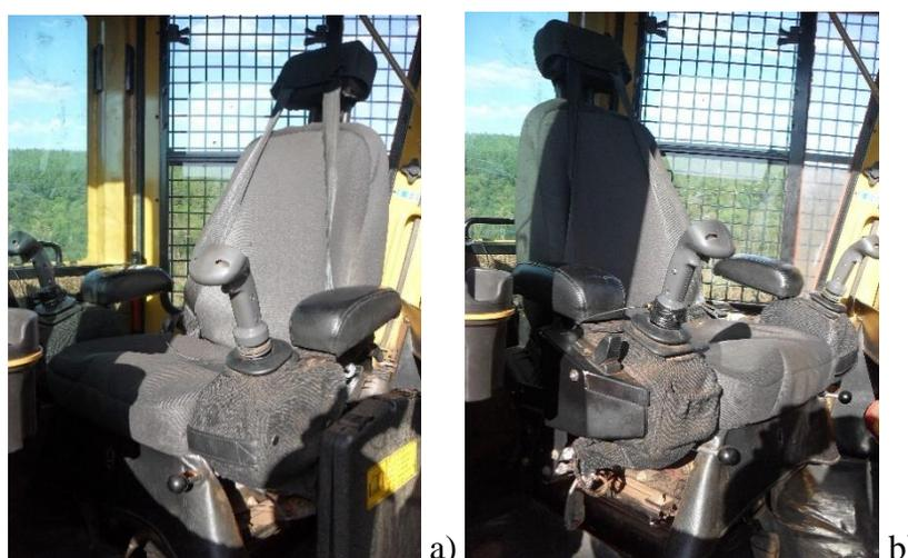
**Figura 5.** Posições do assento do *skidder*. Posição traseira (a); Posição frontal (b).
