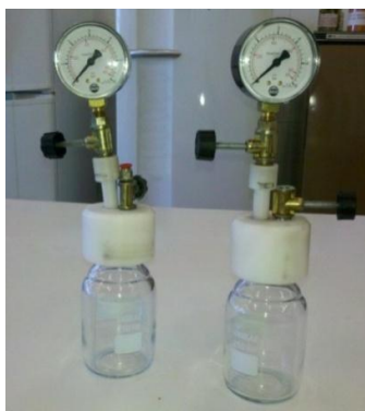
Figura 10. Biodigestores de Bancada (ARQUIVO PESSOAL, 2016).
