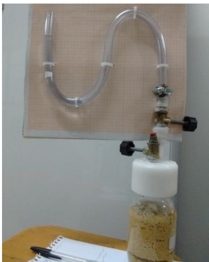
Figura 11. Equipamento de produção de biogás (ARQUIVO PESSOAL, 2017).
