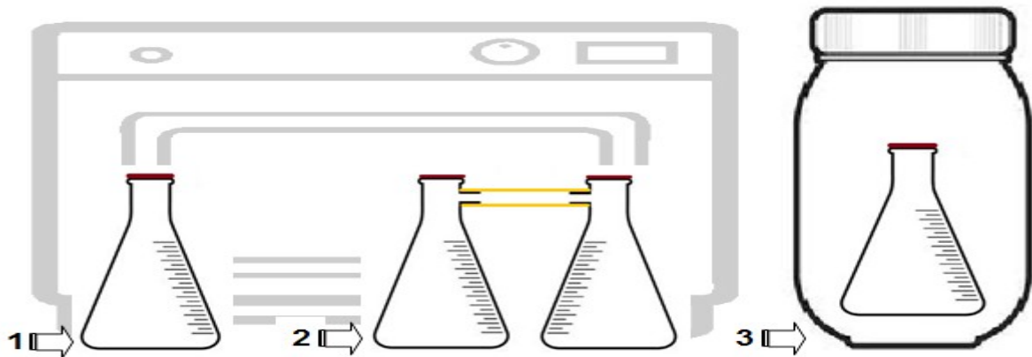
FIGURA 6. Ilustração dos métodos utilizados para fermentação em processo semi anaeróbico em estufa e câmara de anaerobiose.
