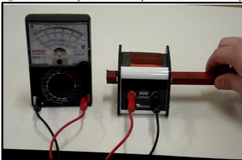
Figura 10: Atividade experimental utilizada para demonstrar a lei de Faraday.
